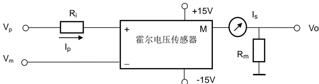
传感器输入端有电压信号( $V_p-V_m$ )并通过主线圈电阻  $R_i$  时, 主线圈电流产生一个磁场, 这一磁场由次级线圈产生的反向磁场所补偿。霍尔元件检测磁补偿, 当磁通量为零时可以得到以下关系式:
